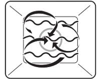
Die Garraumluft wird durch den Heizkörper hinter der Garraumrückwand aufgeheizt und gleichmäßig umgewälzt. Automatisch zugegebene Mikrowellen verkürzen die Gardauer.
