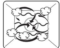
Durch die Beheizung mit Dampf und Heißluft wird das Gargut schonend aufgewärmt und trocknet nicht aus. Die zusätzliche, automatische Zugabe von Mikrowellen verkürzt die Aufwärmdauer.
