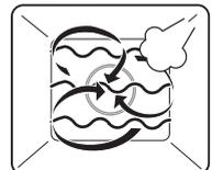
Der Garraum wird mit Heißluft beheizt. Automatisch zugegebene Dampfschwaden und Mikrowellen sorgen dafür, dass die Energie effizienter auf das Gargut übertragen wird und sich dieses schneller erwärmt. Der Garprozess wird dadurch verkürzt.
