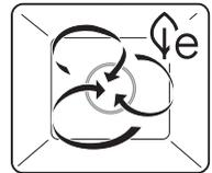
Diese Anwendung ist besonders energiesparend. Die Garraumluft wird durch den Heizkörper hinter der Garraumrückwand aufgeheizt und gleichmäßig umgewälzt. Die austretende Eigenfeuchtigkeit der Lebensmittel wird im Garraum gehalten. Das Gargut trocknet weniger aus.
