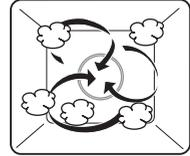
Der Garraum wird gleichzeitig mit Dampf und Heißluft beheizt. Das Gargut wird durch Dampf erhitzt bzw. gegart.
