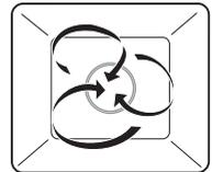
Die Garraumluft wird durch den Heizkörper hinter der Garraumrückwand aufgeheizt und gleichmäßig umgewälzt.
