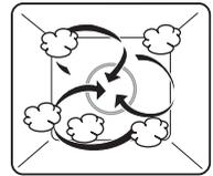
Der Garraum wird mit Dampf und Heißluft beheizt. Das Gargut wird schonend aufgewärmt und trocknet nicht aus.
